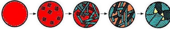
Рис. 12.1. Схема кристалізації скла при утворенні ситалу за допомогою каталізаторів ( \text{Cr}_2\text{O}_3 , \text{FeS} , \text{V}_2\text{O}_5 )
