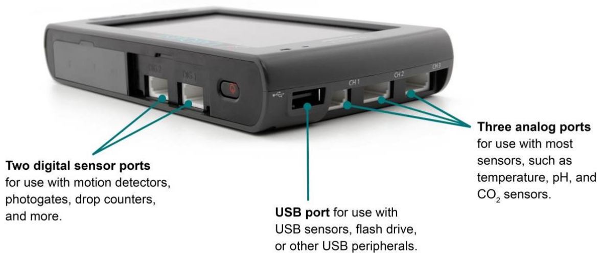
Рис. 5. Цифрові, аналогові порти сенсорів та USB-порт LabQuest 2.
